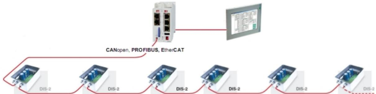
DIS-II Servoregler lassen sich flexibel in nahezu alle Automatisierungskonzepte einbinden. Mit zwei Rundsteckern für Bus IN / Bus OUT sind mehrere DIS-II Antriebsachsen kostengünstig vernetzbar. Der Feldbus wird einfach von DIS-II zu DIS-II durchgeschliffen. Lange und separate Busleitungen zu jedem einzelnen Antrieb und teure T-Weichen können somit entfallen.
