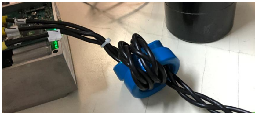
Abbildung 4: Ungeschirmtes Motorkabel mit Ringkernen
