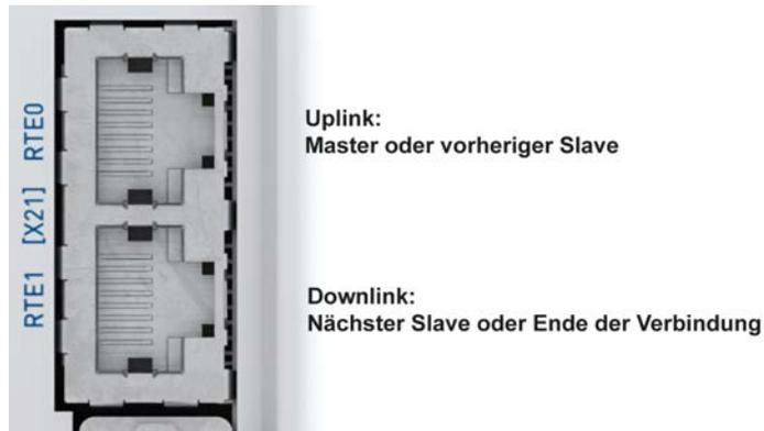
Die beiden Anschlüsse RTE0 und RTE1 sind RJ 45-Buchsen, Cat. 6
