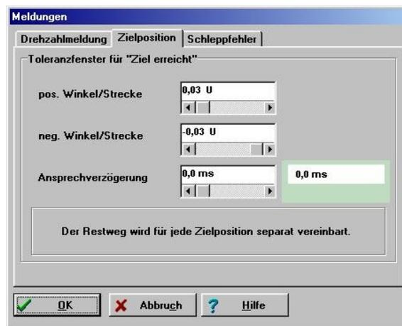
Mit diesen Parametern kann man die Funktion  $X_{\text{ist}} = X_{\text{Ziel}}$  eines digitalen Ausgangs steuern.
