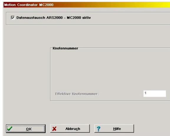
Über das Kontrollkästchen **Datenaustausch ARS2000 - MC2000 aktiv** kann die Kommunikation des Grundgerätes (ARS 2000) mit dem Motion Control -Technologiemodul (MC2000) ein- bzw. ausgeschaltet werden.
