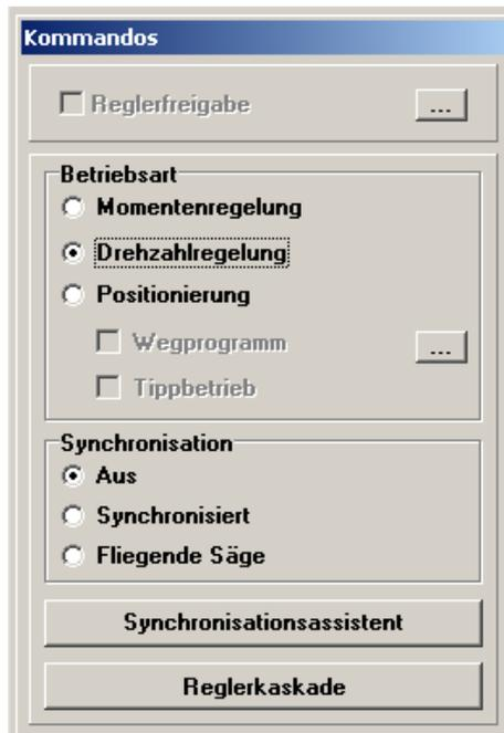
Über das Menü **Betriebsmodus/Reglerkaskade** erhalten Sie eine vereinfachte regelungstechnische Darstellung für diese Betriebsart, die der weiteren Menüführung dient.
