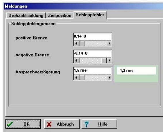
Mit diesen Parametern kann man die Funktion "Schleppfehler" eines digitalen Ausgangs steuern.
