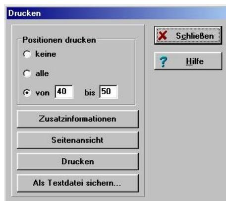
Über die Box **Positionen drucken** können Sie angeben, welcher Teil der Positionsliste gedruckt werden soll. Die Grundparametrierung wird immer gedruckt. Optional können die Daten der Positionierung in die Druckausgabe mit hineingenommen werden.
