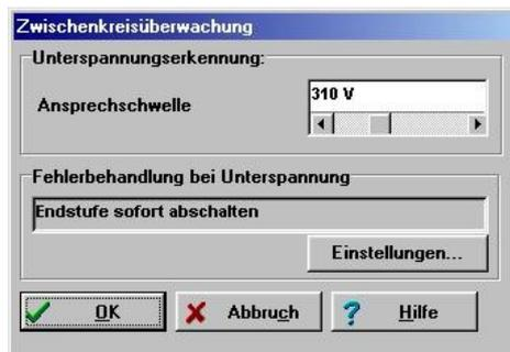
Im Feld **Ansprechschwelle** können Sie vorgeben, unter welchen Wert die Spannung absinken muss, damit der Regler eine Unterspannung erkennt.
