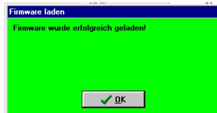
Falls der Firmware-Download nicht erfolgreich war, wird dies durch die Meldung Fehler beim Firmware-Download angezeigt. Ursache ist meist ein Kommunikationsfehler bei der Übertragung der Daten in den Servopositionierregler ARS 2000. Wiederholen Sie den oben beschriebenen Vorgang mit einer kleineren Baudrate.
