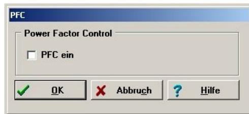
Der Einsatz der PFC stellt im stationären Betrieb die Aufnahme eines sinusförmigen Netzstromes sicher. Dies führt zur Einhaltung der entsprechenden EN-Norm (Netzoberwellen). Darüber hinaus bietet die erhöhte Zwischenkreisspannung eine Leistungsreserve für Ihren Antrieb. Unter folgenden Umständen kann die PFC nicht eingesetzt werden:
