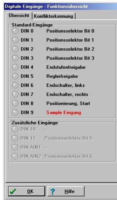
Bei einer mehrfachen Belegung von digitalen Eingängen sind diese in roter Schrift dargestellt. Sie können jetzt auf den Reiter Konflikterkennung klicken, um die mehrfache Belegung zu analysieren.
