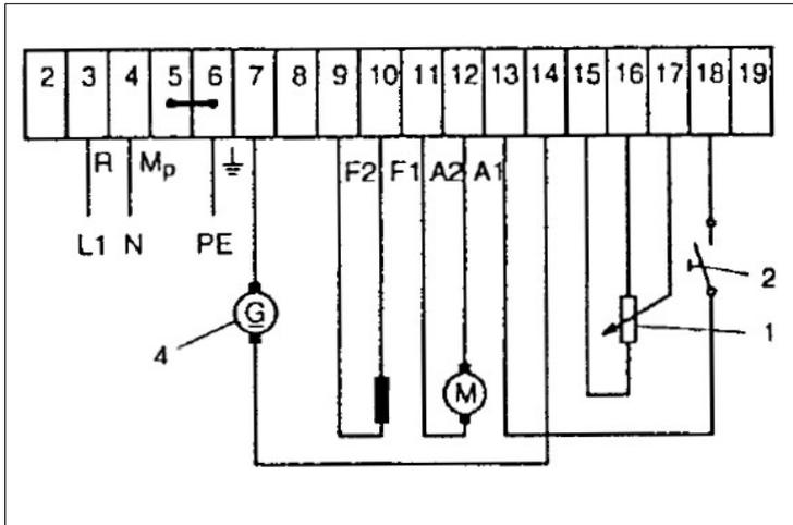
Gerät nach Anschlussbild anschließen Gleichstromtacho an Klemmen 7 (+) und 14 (-) anschließen.
