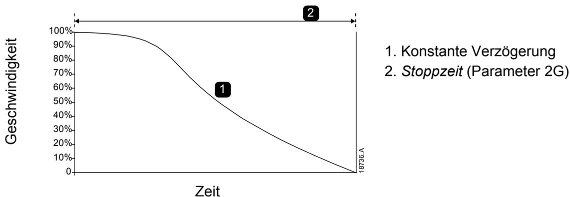
Die Adaptive Regelung eignet sich sehr gut für Pumpenanwendungen und kann die zerstörerischen Auswirkungen von Druckschlägen stark eingrenzen.
